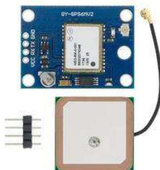
Figura 6. Ejemplo de módulo GPS de GY-NEO6MV2 NEO6MV2
