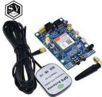
Figura 9. Ejemplo de Módulo SIM808.
