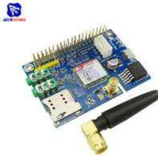
Figura 7. Ejemplo de Diymore módulo GSM-GPRS SIM800C
