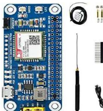
Figura 10. Ejemplo de NB-IoT/Cat-M(eMTC)/GNSS.
